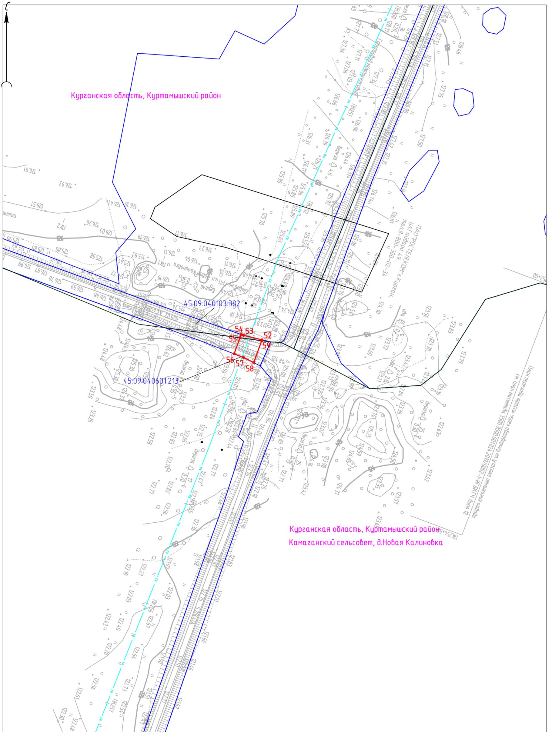
План перехода трассы через автомобильную дорогу на участке отпайки отвода
